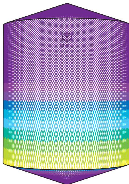
D2,5m H6m, Toftejorg TZ-67, 4 x ø6 mm, durée = 14,7 mn, consommation d'eau = 3097 l (818 gallons)
